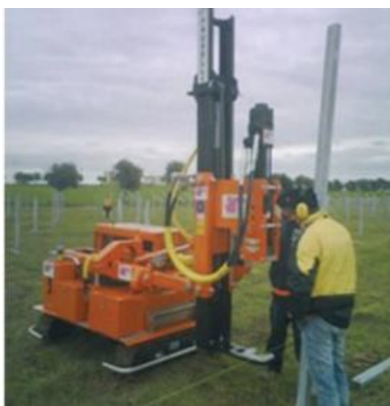
Fotografia 4.9 – Maquinaria utilizada para a estacagem
