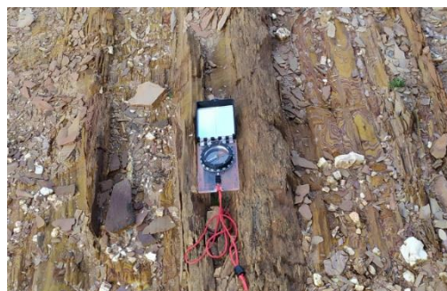
Pormenor dos leitos milimétricos, das intercalações xistentas, com direção N55W com inclinação sub-vertical, muito alterados
