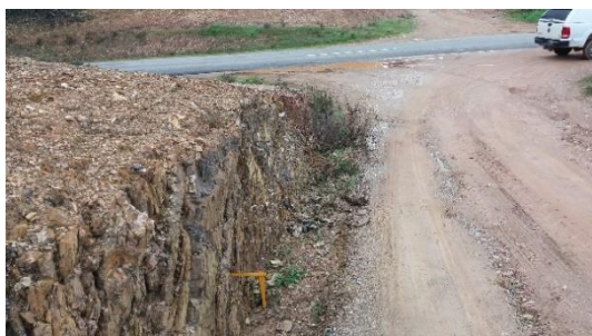
Talude com afloramento da Formação de Mira. A direção do plano das bancadas centimétricas é N45W, inclinado cerca de 80° para N45E.
