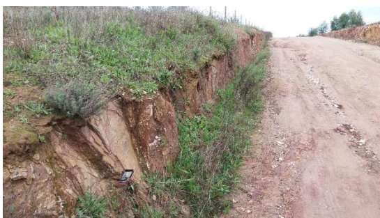
Talude com afloramento da Formação de Mira. A direção do plano das bancadas centimétricas é N45W, inclinado cerca de 80° para N45E.
