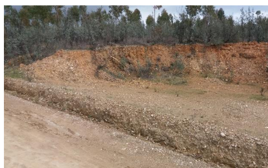
Pormenor dos leitos milimétricos, das intercalações xistentas, com direção N55W com inclinação sub-vertical, muito alterados
